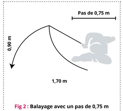
Fig 2 : Balayage avec un pas de 0,75 m
