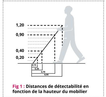
Fig 1 : Distances de détectabilité en fonction de la hauteur du mobilier
