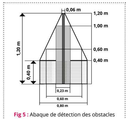
Fig 5 : Abaque de détection des obstacles
