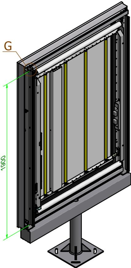
Contre-percer au Ø4.2 pour placer les vis tôle Ø4.8 ou des rivets TP Ø4x10
